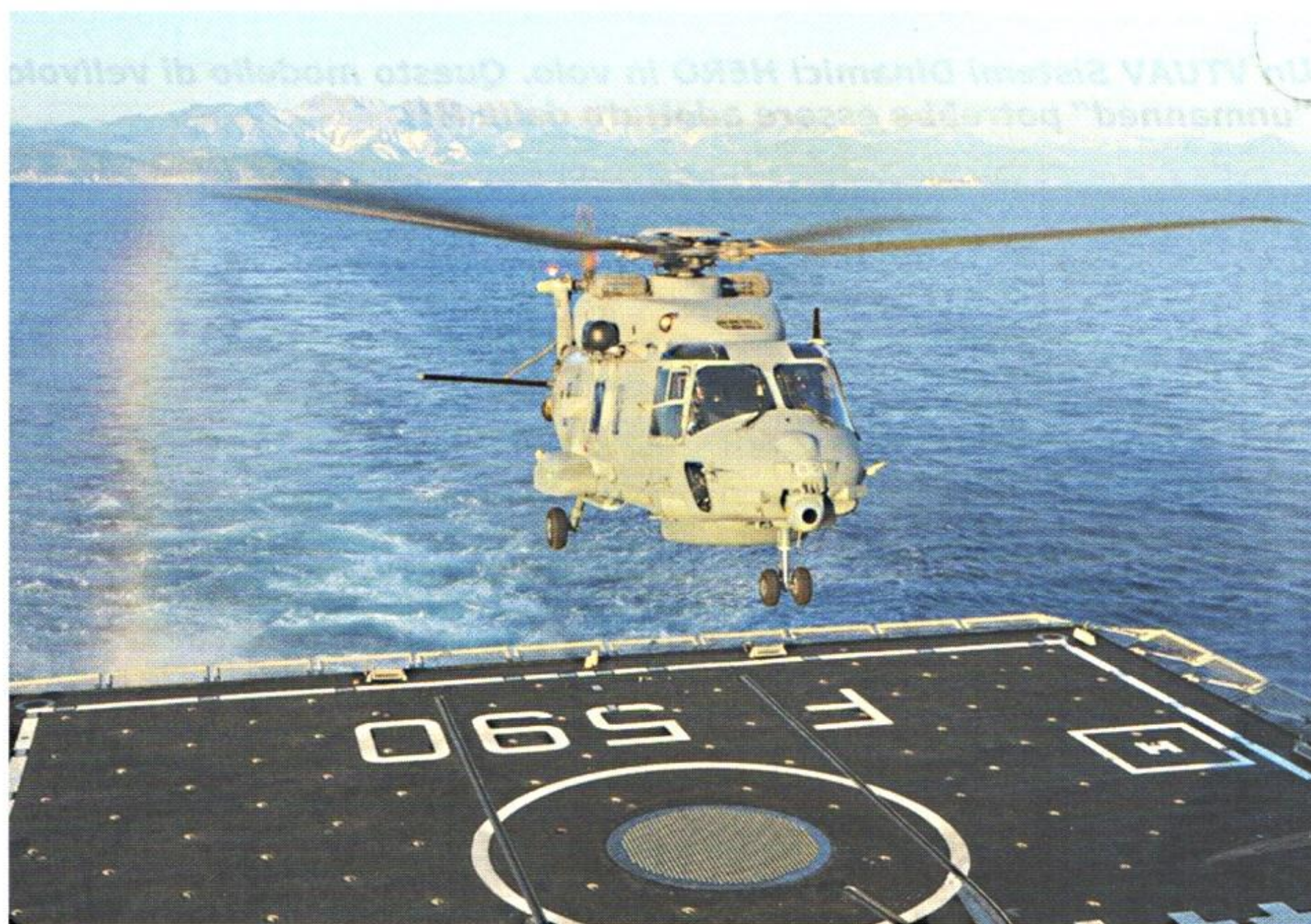
Un SH-90A in fase di appontaggio sulla fregata BERGAMINI. Notare sul ponte di volo la griglia di aggancio del sistema TC-ASIST.
