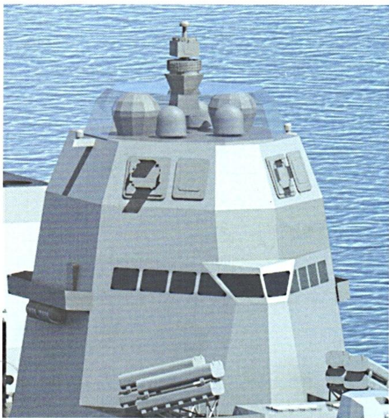
La tuga di un PPA in configurazione Full. Notare, oltre alle antenne del Dual Band Radar, il parco antenne dei sistemi di comunicazione e, in cima alla struttura, gli apparati RESM (Radar Electronic Support Measures) e CESM (Communication Electronic Support Measures) della suite da guerra elettronica realizzata da Elettronica.
