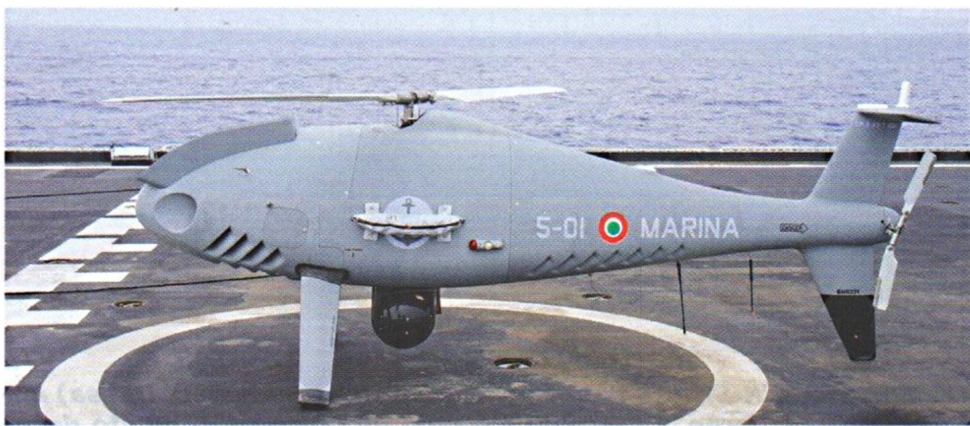
Un VTUAV (Vertical take off and landing Tactical Unmanned Aerial Vehicle) CAMCOPTER S-100 dell'austriaca Schiebel sul ponte dell'LPD SAN GIUSTO. I PPA sono stati progettati per essere pienamente compatibili con i sistemi "unmanned".
